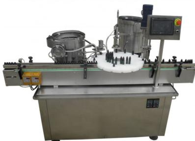
Мини линия - моноблок розлива предназначен для розлива фармацевтических препаратов,
